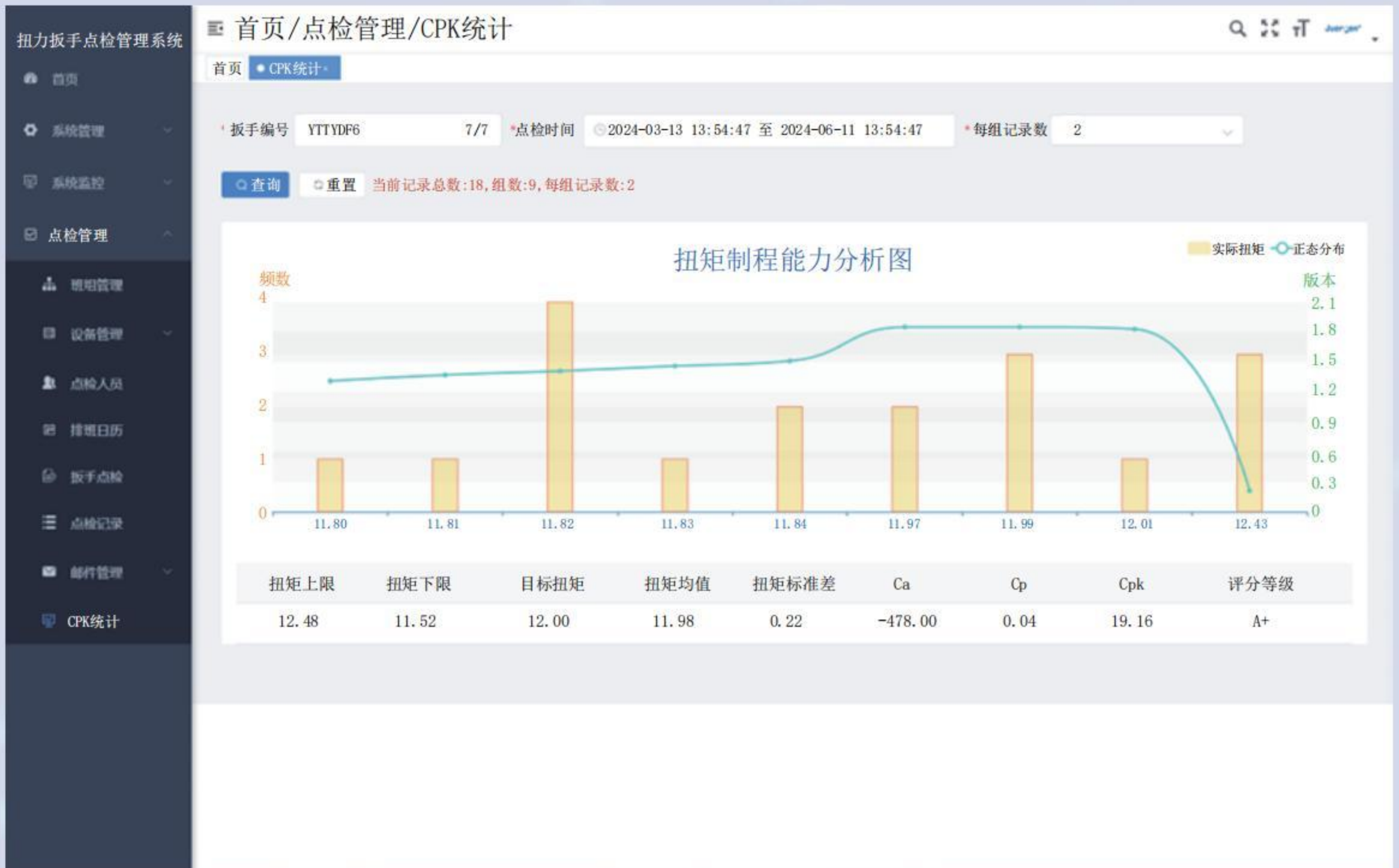
图7 扭力扳手点检系统点检数据CPK分析示例
