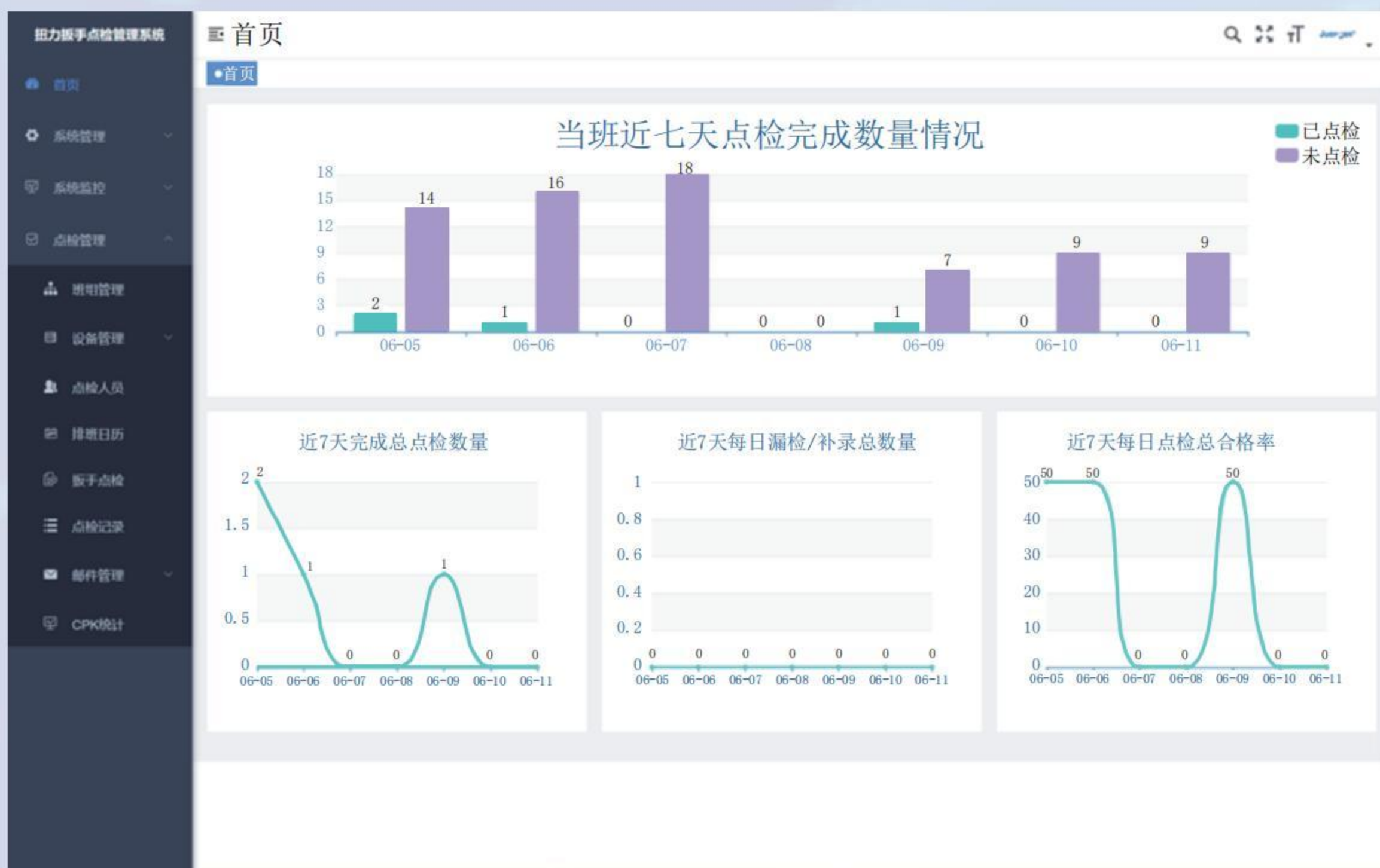
图6 扭力扳手点检系统点检数据统计示例
